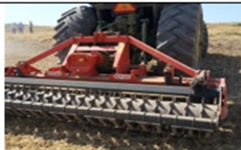
سیکلو تیلر (بعد از شخم برای خرد کردن کلوخه ها)
